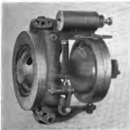
Abbild. 18. Geradlaufapparat mit Luftturbinenantrieb.
