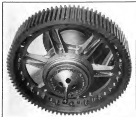
Abbildung 6. Hauptzahnrad im Getriebe des Linke-Hoffmann-R-Flugzeugs.
