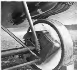
Abbildung 15. Eisernes Rad mit Stahlabfederung im Linke-Hoffmann-R.-Flugzeug.
