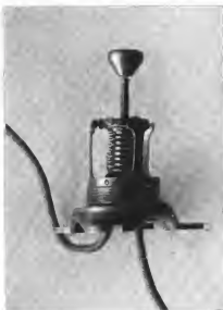
Abbildung 16. Zitterkontakt einer russischen Mine.
