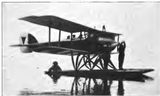
Abbild. 16. L.V.G.-Wasserflugzeug auf Schwimmern, 200 P.S. Benzmotore.
