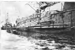
Abbildung 39. Kriegsschiff mit ausgefahrenen Schutznetzen.
