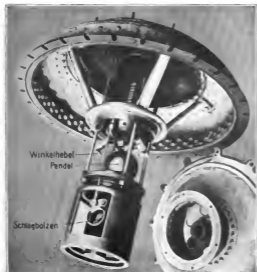
Abbildung 15. Mechanische Zündvorrichtung der französischen Breguet-Mine, Pendel mit entschärfter Stellung.
