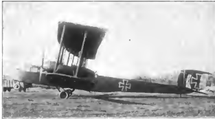
Abbild. 14. Staaken-R.-Flugzeug mit 3 Rümpfen, Hauptrumpf ohne Motore.
