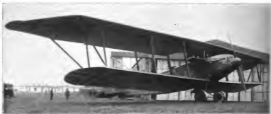
Abbildung 30. Linke-Hoffmann-R.-Flugzeug, zentrale Anlage, 1000 P.S., 1 Schraube.
