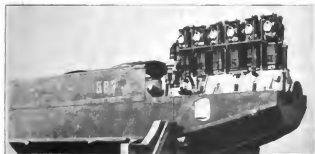
Abbild. 2. Einbau des 200-P.S.-Benzmotors im Junkers-Infanterieflugzeug.
