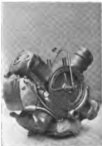
Abbildung 9. Vierzylinder-Maschine mit Ölgefäßen.
