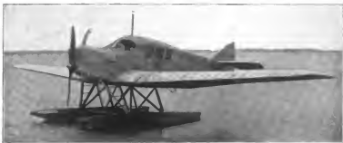
Abbildung 36. Junkers' Verkehrsflugzeug auf Schwimmern, 160 P.S. Mercedes.
