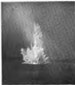
Abbildung 25. Detonation einer Mine 5 m unter der Wasseroberfläche.
