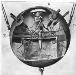
Abbildung 13. Russische Bleikappenmine, Innenraum mit Zünd- und Kontakteinrichtung.
