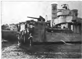
Abbildung 30. Torpedobootzerstörer, dessen Vorderteil durch Minentreffer vernichtet ist.
