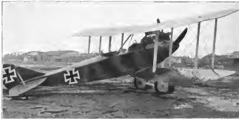
Abbildung 21. Rumpler C. IV u. VII, 260 P.S. Mercedes bzw. 245 P.S. Maybach. Führendes Flugzeug in der Fernaufklärung 1917/18.
