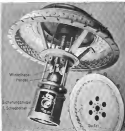
Abbildung 14. Mechanische Zündvorrichtung der französischen Breguet-Mine, Pendel mit gesicherter Stellung.
