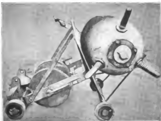
Abbildung 24. Kleine russische Bleikappenmine mit Anker.
